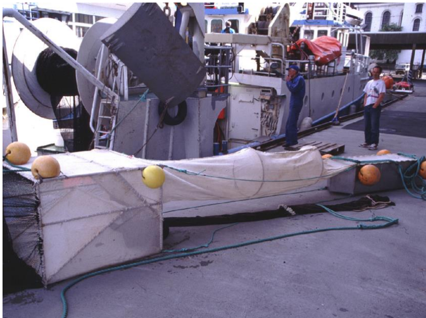
Figur 1. Fish-Lift trålen på land på Nykirkekaian i Bergen foran G.M. Dannevig i 1998, det første året Havforskningsinstituttet trålte etter postsmolt i fjordene. Postsmolten kommer inn i Fish-Lift enheten under de to trålkulene til venstre. Den første fine og skråstilte risten inne i den firkantete rammen presser all fisk oppover, deretter treffer fisken den neste skråstilte risten som har en spileavstand som slipper postsmolt igjennom men ikke større fisk. Postsmolten passerer så bakover i den langstrakte runde kanalen og inn i det strømslille akvariet lengst til høyre. Større fisk presses nedover og ender i trålposen under kanalen. Ved endt trålhal løftes akvariet om bord i fartøyet og tømmes. Deretter sorteres fangsten og smolt blir lagt enkeltvis i plastposer for senere analyse av luspåslag. Metoden er fortsatt i bruk etter 23 år men med et modifisert akvarium. Foto JC Holst.
